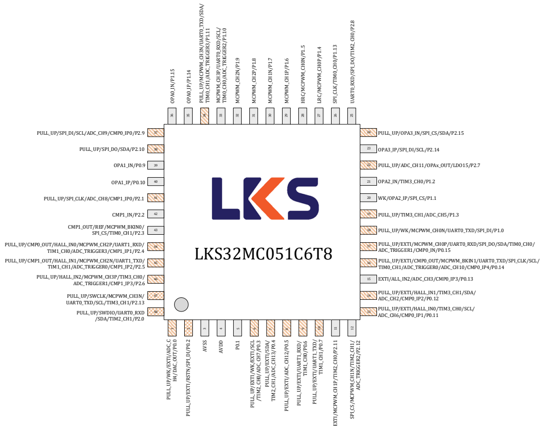
图 3-1 LKS32MC051C6T8 管脚分布图
